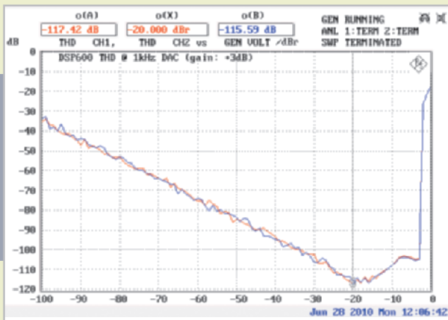
Abb. 3: THD bei 1 kHz in Abhängigkeit vom Eingangspegel gemessen vom digitalen Eingang zum analogen Ausgang mit +3 dB internem Gain. 17 dB unter Vollaussteuerung (bei +4 dBu Ausgangsspannung) wird ein äußerst guter Wert von -117 dB erreicht. Auch direkt unterhalb der Clippinggrenze bei +21 dBu am Ausgang liegt der Wert immer noch deutlich unterhalb von -100 dB.
