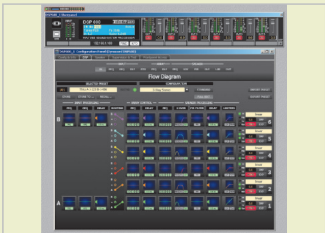
Abb. 10: IRIS-Net-Bedienoberfläche mit Blockschaltbild des Controllers. Sehr schön wird hier auch in der Übersicht schon angezeigt, welche Funktionen in den Modulen genutzt werden und sogar welche Filterkurven und Limiterkennlinien eingestellt sind.
