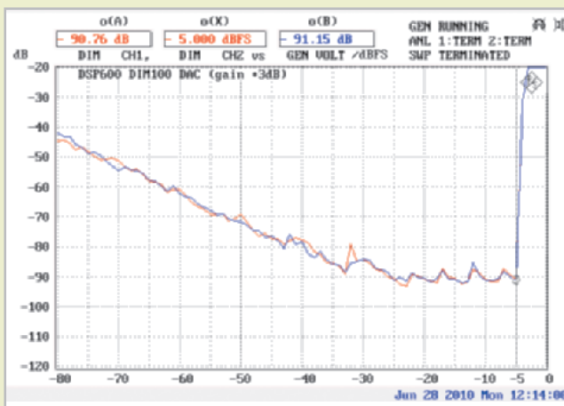
Abb. 5: Transiente Intermodulationsverzerrungen gemessen vom digitalen Eingang zum analogen Ausgang mit +3 dB internem Gain. Die Clippinggrenze liegt bei dieser Art Testsignal bei -2 dBfs und zusammen mit den 3 dB Gain dann bei -5 dBfs.
