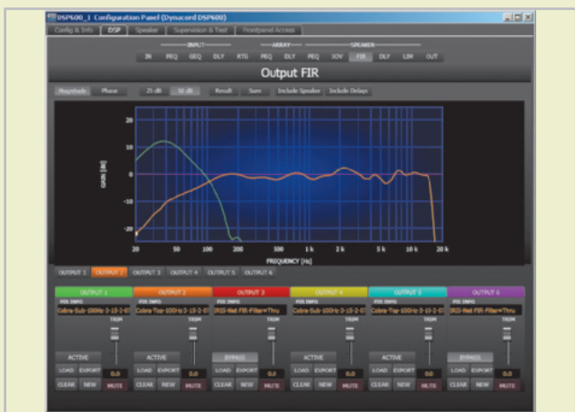
Abb. 14: Bedienfeld für die FIR-Filter mit frei wählbaren Hoch- und Tiefpassfunktionen und individuellen Lautsprecherentzerrungen. Letzteres ist jedoch nur den in der FIR-Filter-Bibliothek vorhandenen EV- und Dynacord-Produkten vorbehalten.
