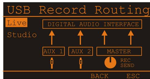
Durch Drehen des MENU/ENTER-Drehencoders kann die Zuordnung von Bussen des CMS zu den vier Kanälen USB 1 bis 4 gewählt werden. Es steht eine Zuordnung für den Live-Betrieb und eine Zuordnung für den Studio-Betrieb zur Verfügung, siehe folgende Tabelle. Drücken des MENU/ENTER-Drehencoders übernimmt die gewählte Zuordnung. Drücken der BACK-Funktionstaste führt in das Menü zurück. Drücken der ESC-Funktionstaste führt in die Effekt-Betriebsart zurück.
