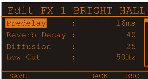
Im Edit FX Menu kann durch Drehen des MENU/ENTER-Drehencoders ein Eintrag in der linken Spalte markiert und durch Drücken des MENU/ENTER-Drehencoders der entsprechende Wert in der rechten Spalte ausgewählt werden. Der ausgewählte Wert wird nun durch Drehen des MENU/ENTER-Drehencoders angepasst. Erneutes Drücken des MENU/ENTER-Drehencoders führt in die linke Spalte zurück. Um den editierten Effekt in einen User Preset-Speicherplatz abzuspeichern drücken Sie die
