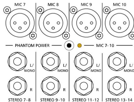
Abbildung 2-9: Belegung der XLR-Mikrofon-Eingänge
