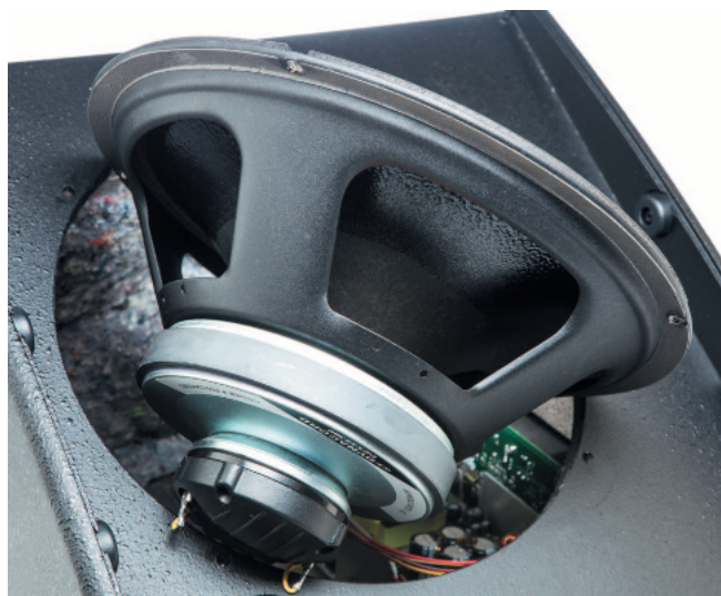
Coax-System mit aufgesetztem Neodym-Kompressionstreiber für die Höhen
