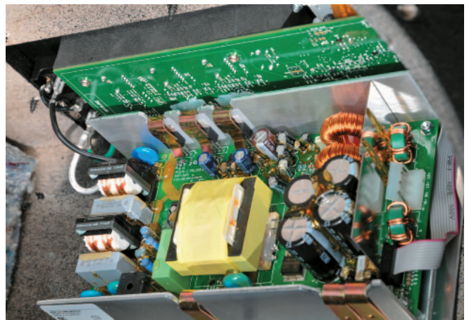
Das solide verbaute Elektronikmodul mit Schaltnetzteil, Endstufen und Controller
