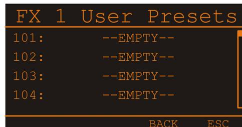
Wählen Sie im FX User Presets Dialog den gewünschten Speicherplatz durch Drehen des MENU/ENTER-Drehencoders. Drücken des MENU/ENTER-Drehencoders öffnet den Set FX Name Dialog.
