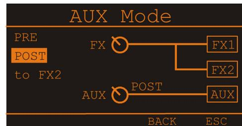
Die Monitorlautstärke wird über den AUX-Fader im Master eingestellt. Beachten Sie aber, dass ein Aufziehen eines Kanalfaders sich auf den Monitormix auswirkt und bei unbedachter Bedienung eine erhebliche Rückkopplungsgefahr besteht. Sie haben bei dieser Art des Monitorings natürlich die Möglichkeit, über die jeweiligen AUX-Regler im Kanal, bestimmte Kanäle z. B. Bass-Drum oder Snare, die naturgemäß sowieso sehr laut auf der Bühne vorhanden sind, einfach leiser zu drehen.
