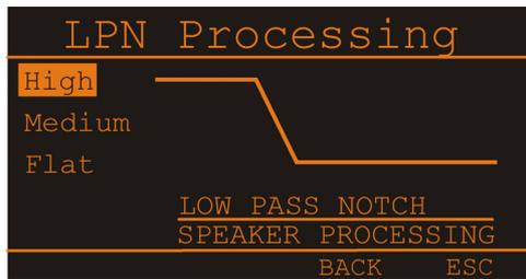
Im LPN Processing Dialog kann durch Drehen des MENU/ENTER-Drehencoders zwischen verschiedenen Einstellungen des LPN-Filters gewählt werden, siehe folgende Tabelle. Drücken des MENU/ENTER-Drehencoders übernimmt die gewählte Einstellung. Drücken der BACK-Funktionstaste führt in das Menü zurück. Drücken der ESC-Funktionstaste verwirft alle im Dialog vorgenommenen Änderungen und führt in die Effekt-Betriebsart zurück.
