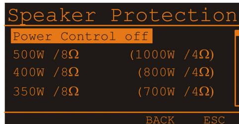
Zur Deaktivierung der Schutzschaltung wählen Sie den Eintrag „Power Control off“. Drücken des MENU/ENTER-Drehencoders übernimmt die gewählte Einstellung. Drücken der BACK-Funktionstaste führt in das Menü zurück. Drücken der ESC-Funktionstaste verwirft alle im Dialog vorgenommenen Änderungen und führt in die Effekt-Betriebsart zurück.
