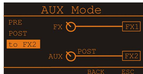
In dieser Betriebsart wird der AUX-Kanal als FX 2-Send verwendet. Mit dem AUX-Reglern in den Eingängen können Sie also das jeweilige Eingangssignal dem eingebauten Digital-Effektgerät FX 2 stufenlos zumischen. Die FX-Regler in den Eingangskanälen wirken in dieser Betriebsart als FX 1-Regler, das damit erstellte Signal wird also nur dem Digital-Effektgerät FX 1 zumigemischt (siehe auch Seite 48).
