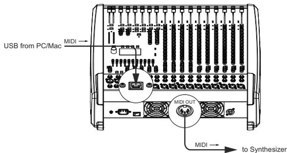
Abbildung 4-5: Übertragung von MIDI-Daten von einem Master Keyboard zum PC/Mac (Abbildung zeigt PowerMate 1000-3)
