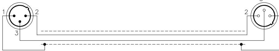
Bild 2 NF-Verbindungskabel zur Koppelung von zwei Verstärkern DPA 41xx
