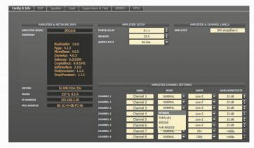
ABB. 03: Info- und Konfigurationsfenster des Amps
