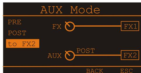
In dieser Betriebsart wird der AUX-Kanal als FX 2-Send verwendet. Mit dem AUX-Reglern in den Eingängen können Sie also das jeweilige Eingangssignal dem eingebauten Digital-Effektgerät FX 2 stufenlos zumischen. Die FX-Regler in den Eingangskanälen wirken in dieser Betriebsart als FX 1-Regler, das damit erstellte Signal wird also nur dem Digital-Effektgerät FX 1 zugemischt (siehe auch Seite 46).
