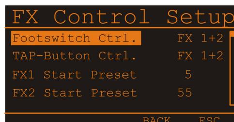
Im FX Control Setup Dialog kann durch Drehen des MENU/ENTER-Drehencoders ein Eintrag in der linken Spalte markiert und durch Drücken des MENU/ENTER-Drehencoders der entsprechende Wert in der rechten Spalte ausgewählt werden. Der ausgewählte Wert wird nun durch Drehen des MENU/ENTER-Drehencoders angepasst und der neue Wert durch Drücken des MENU/ENTER-Drehencoders übernommen.
