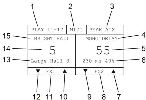
Durch Drücken der Tasten unter dem Display können schnell und unkompliziert die verschiedenen Effekte ausgewählt werden.
