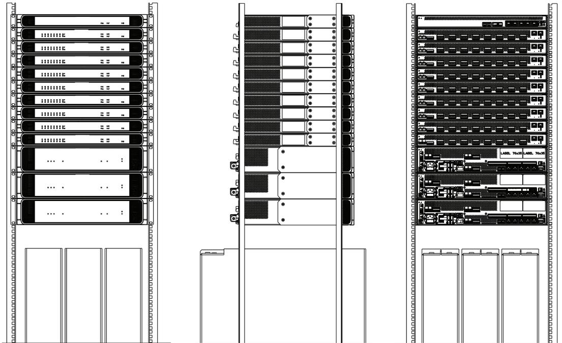
Solange das Rack über eine gute Belüftung verfügt, können alle Systemkomponenten direkt übereinander eingesetzt werden. Achten Sie darauf, dass die Betriebstemperatur im Rack maximal +50 °C beträgt.
