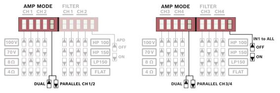
Figura 5.2: Configuração de roteamento de entrada (somente os canais 3 e 4 V600:4)
