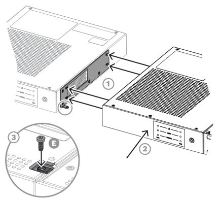
Figura 4.5: Dois amplificadores ligados com a placa de conexão montada e o parafuso M3 para impedir o rebaixamento
