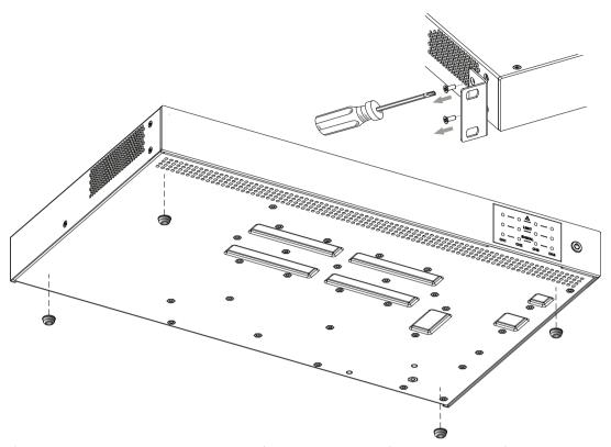
Figura 4.2: Desmontagem das alças do rack (parte superior direita) e colocação dos pés de borracha (parte inferior)
