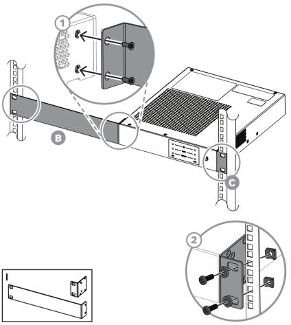
Figura 4.3: Montagem autônoma em um rack de 19 pol.
