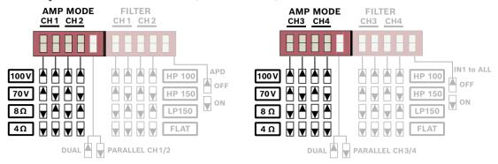
Figura 5.1: Configuração do modo de saída (somente os canais 3 e 4 do V600:4)
