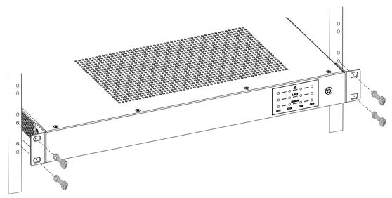
Figura 4.1: Montagem do amplificador em um rack
