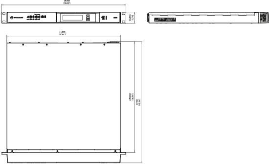
Abbildung 7.1: Abmessungen: MXE5
