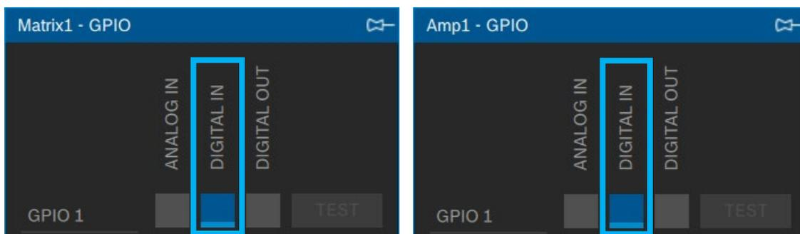
**Imagens 23 e 24:** Configuração do *GPIO 1* de *Matrix1* (esquerda) ou *Amp1* (direita) para *DIGITAL IN*.
