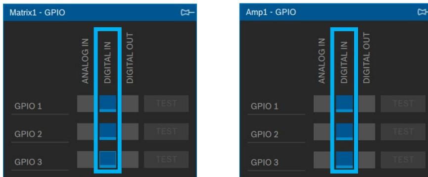
**Imagen 34 y 35:** Configuración de Matrix1 (izquierda) o Amp1 (derecha) GPIO 1, 2 y 3 como DIGITAL IN.
