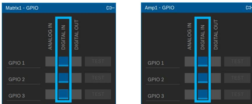
**Image 34 et 35** : Réglage de Matrix1 (à gauche) ou Amp1 (à droite) GPIO 1, 2 et 3 sur DIGITAL IN.
