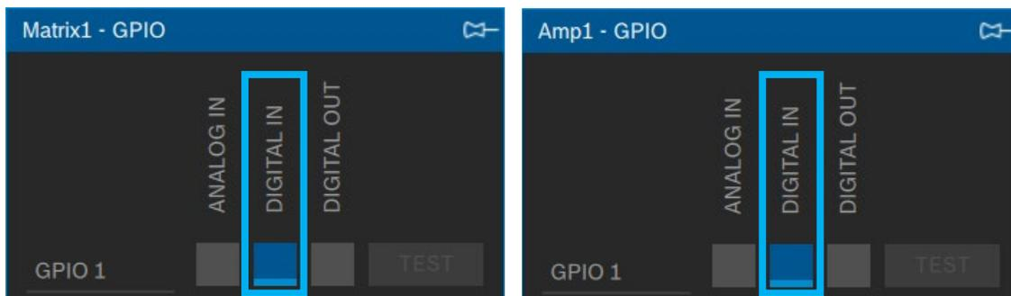
**Image 29 et 30** : Réglage de *Matrix1* (à gauche) ou *Amp1* (à droite) GPIO 1 sur **DIGITAL IN**.
