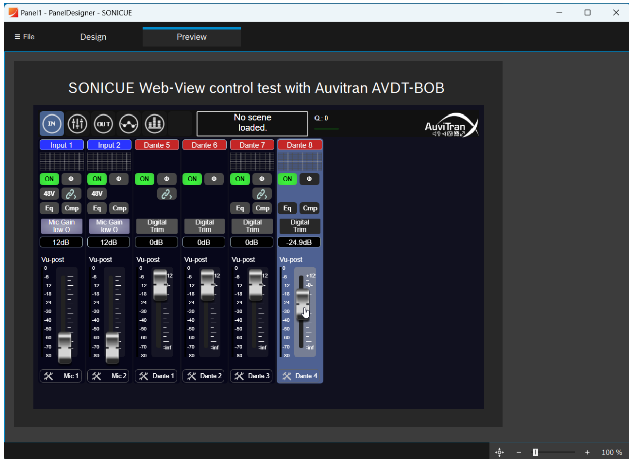
Imagem 11: Painel SONICUE criado com o PanelDesigner exibindo a UI da Web de um AuviTran AVDT-BOB
