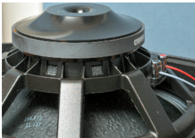
15"-Treiber von EV in der PSD15. Gut zu erkennen sind die Belüftungen der Schwingspule mit den kleinen Gitterchen zum Schutz vor eindringendem Schmutz
