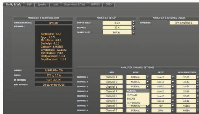
**ABB. 03:** Info- und Konfigurationsfenster des Amps
