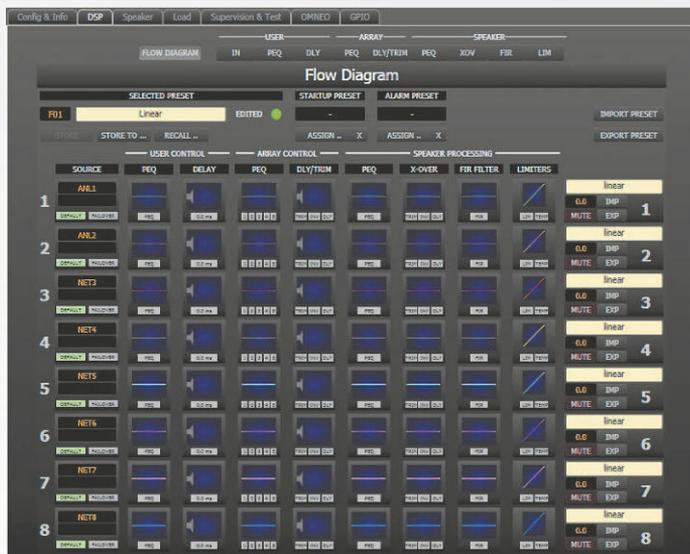
ABB. 04 DSP-Tab mit einem Blockschaltbild der Signalverarbeitung
